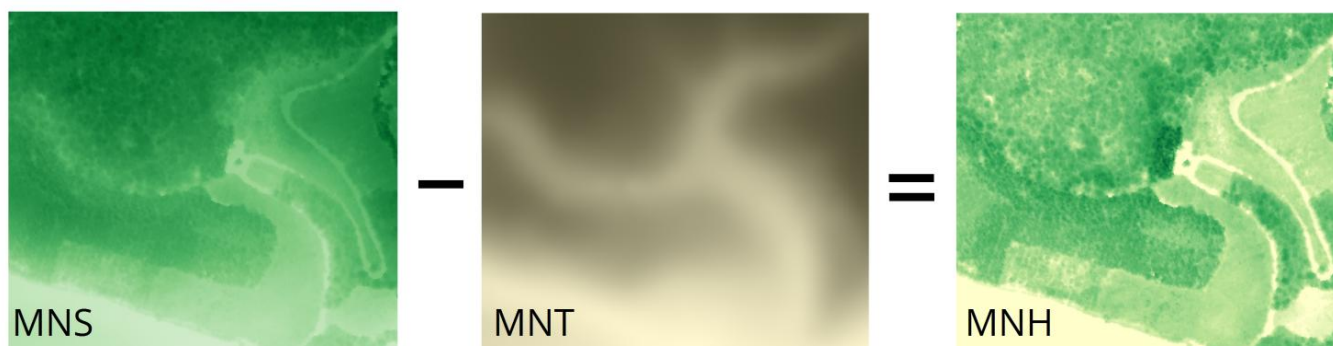
Figure 3 : Méthode d'obtention du modèle numérique de hauteur (MNH). Dans cet exemple, plus la teinte est foncée et plus le peuplement est haut.
